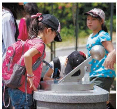
高さ70センチのみかげ石の台座に、直径45センチの時計盤と、影を落とす三角形投影板が組み合わされています。投影板の上に小さな地球儀があり、その一番てっぺんがこどもの国のある場所です。地球儀への日の当たり方が、地球への当たり方と同じになります。こどもの国は、日本標準時の兵庫県明石市よりも東にあるので、日の差し方が少し早くなります。5分刻みの時計盤に示される時刻から、台座にある時差表で調べた誤差を引きます。こうして測った時刻は、とても正確だそうです。小原氏の長女で日時計作家の小原輝子さんが設計しました。けがをしないよう台座の角を丸くし、下をくぐって遊べるような形にしました。記念プレートは鏡のようにして顔を映せるなど、遊びの要素を取り入れたそうです。晴れた日に、日時計の影の動きを見てください。太陽と地球の動き、時間の流れを実感できますよ。
